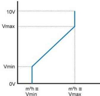
Der Wert  $m^3h \equiv V_{min}$  kann höher oder niedriger sein als  $m^3h \equiv V_{max}$ .
