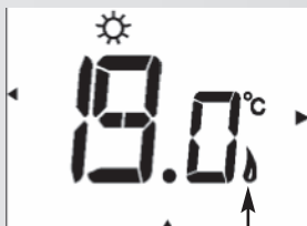
Heizanzeige des Heizkörpers
